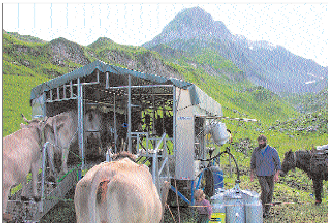
Flugtauglich: Dieser Melkstall in der Nähe des Pfannenstocks kann in zwei Helibewegungen weggeflogen werden.
